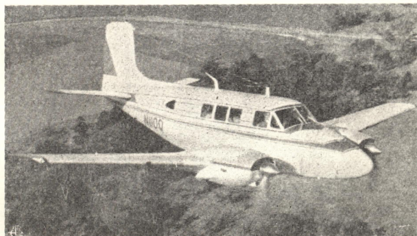
O BEECHCRAFT QUEEN AIR de 7 lugares é um bimotor de negócios dotado do mais completo equipamento electrónico. Velocidade 300 km/h
