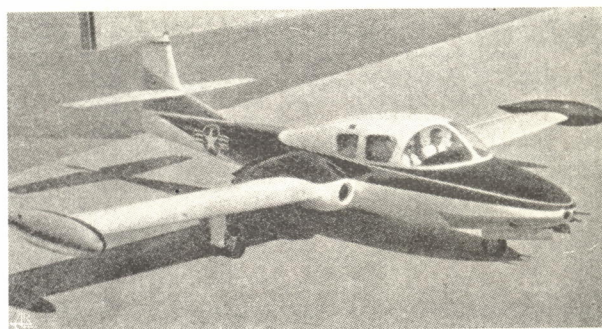
O CESSNA 407 de 4 lugares, cabine pressurizada está equipado com dois tubo-reactores. Continental J-69 Velocidade 726 km/h
