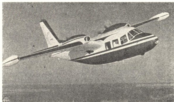
O PIAGGIO P-166 bimotor de negócios de 6 lugares com bar toilette e grande compartimento para bagagem. Velocidade 300 km/h Autonomia 800 km.
